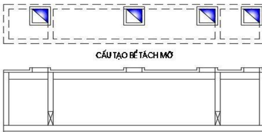
Hình 12. Sơ đồ nguyên lý hoạt động bể tách mỡ
